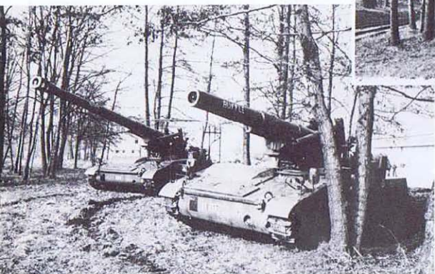
La modification par rapport au modèle actuel consiste dans le remplacement du tube par un autre beaucoup plus long (8,24 m), auquel s'ajoute un frein de bouche à double déflecteur qui, à lui seul, pèse 250 kg. Il en résulte un accroissement considérable de la portée. De ce fait, par exemple, les artilleurs du 20 A installés à Arlon pourraient appuyer efficacement et sans difficultés un assaut lancé par notre... Solitaire de Martelange.
